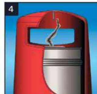
Steg 4 Elden kvävs då inget syre tillförs.
