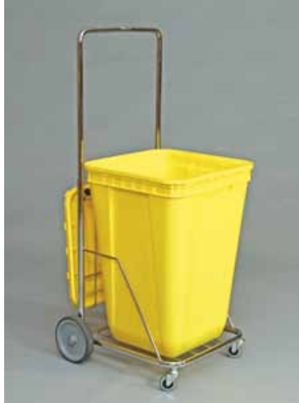
Art nr 8075-00 All-roundvagn för bl a riskavfallsboxar. Med höj/sänkbart handtag vilket underlättar t ex vid intertransport till miljö- rum. Förkromad, 2 länkhjul Ø 50 mm och 2 fasta hjul Ø 150 mm. B x d x h = 470x470x710/1035 mm.
